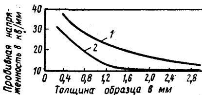
Рис. 16. Зависимость пробивной напряженности от толщины образца при f=50 Гц
